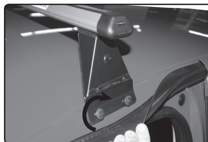
Do otvoru v patce prostrčte šroub a pevně utáhněte pomocí klíče Torx T25. Takto utáhněte všech 8 šroubů.
