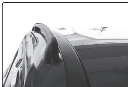
Přední patku umístěte 8 mm od vnější hrany střešní lišty vozu.
