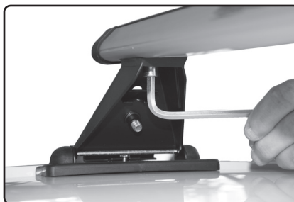
Překontrolujte pevné utažení šroubů M8x18 přiloženým klíčem (imbus č.6).
