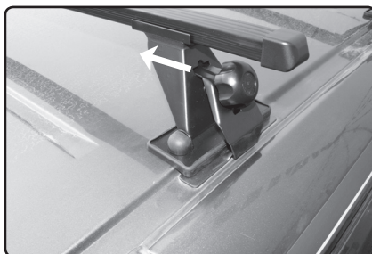
Posuňte patky nosníku na co nejmenší možnou rozteč s tím, že boční úchyty zůstávají stále pod přípravkem. Rozteč šroubů M8x18 s imbusovou hlavou, které fixují patku nosiče k tyči by měla odpovídat rozteči „D“ uvedené v tabulce na titulní straně.
