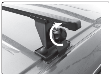
Pevně utáhněte šroub M8x35 s plastovou hlavou na obou stranách nosníku. Šroub neutahujte nadměrnou silou, aby nedošlo k deformaci bočního úchytu a špatnému upevnění nosiče.
