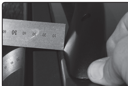
Přední patku umístěte 5 mm od vnější hrany kovové střechy vozu.
