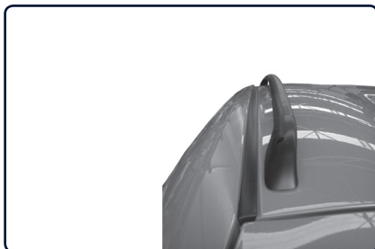
Podélný střešní nosič se instaluje na vnitřní stranu od lišty střechy vozu.
