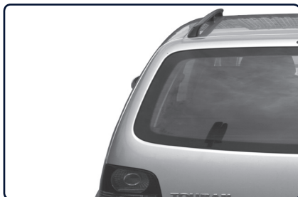
Podélný střešní nosič se instaluje na vnitřní stranu prolisu na sníženou plochu střechy vozu.
